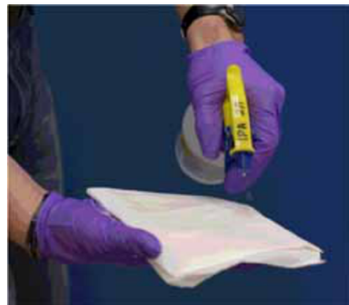
Figure 6. Imbiber un chiffon non pelucheux
